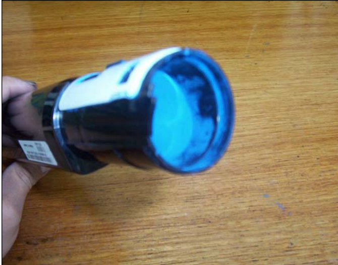
7. Este es el deposito de desecho del Revelador que tendrá que ser vaciado. En el fondo encontrará el tapón de carga del toner. Retirar el mismo para limpieza y recarga.
