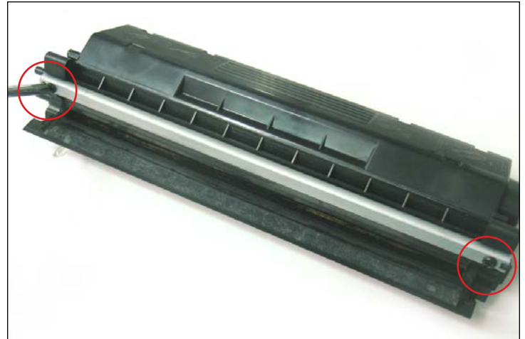
27. Destornillar y sacar la cuchilla dosificadora. Limpiar el borde con un paño suave y un poco de alcohol.
