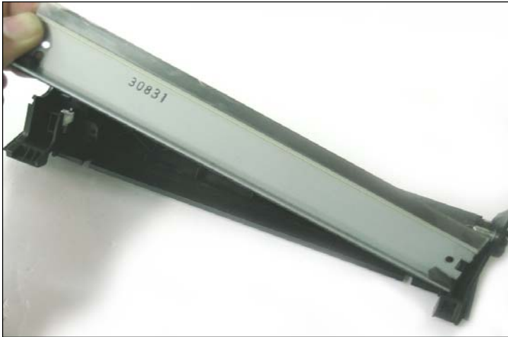
15. Extraer la cuchilla y vaciar el deposito de todo resto de toner. Limpiar el depósito con aire comprimido o aspiradora.
