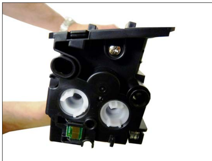
14. Instale la cubierta superior y los cuatro tornillos.
