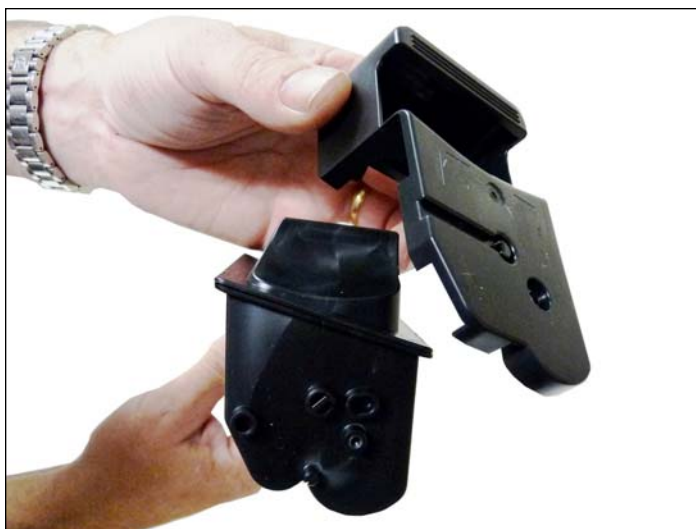
4. Deslice la cubierta hacia arriba y afuera del cartucho.
