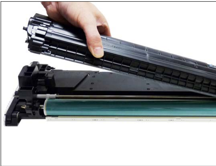
6. Levante la unidad del revelador del cartucho.
