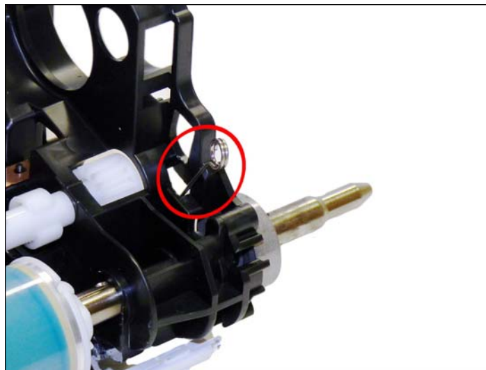
26. Instale el resorte grande de manera que la base encaje en el poste y la cola encaje en el agujero como se muestra.
