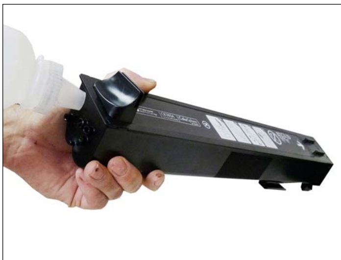
6. Limpie todo el tóner de desperdicio, y llene con tóner dedicado HP CLJ CP6015.
