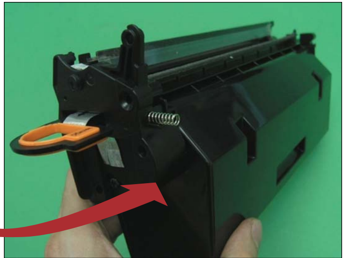
14. Ahora instale la cubierta lateral izquierda dentro del lado izquierdo de la cavidad. La cubierta lateral izquierda P2015 incluye la lengüeta igual que el OEM, pero no incluye el clip naranja. El clip naranja esta disponible por separado o puede usar el clip naranja OEM. Apriete todos los tornillos en la cubierta lateral izquierda.
