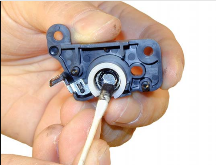
22. Limpie la placa de contacto del rodillo magnético en el contacto de la cubierta lateral.
