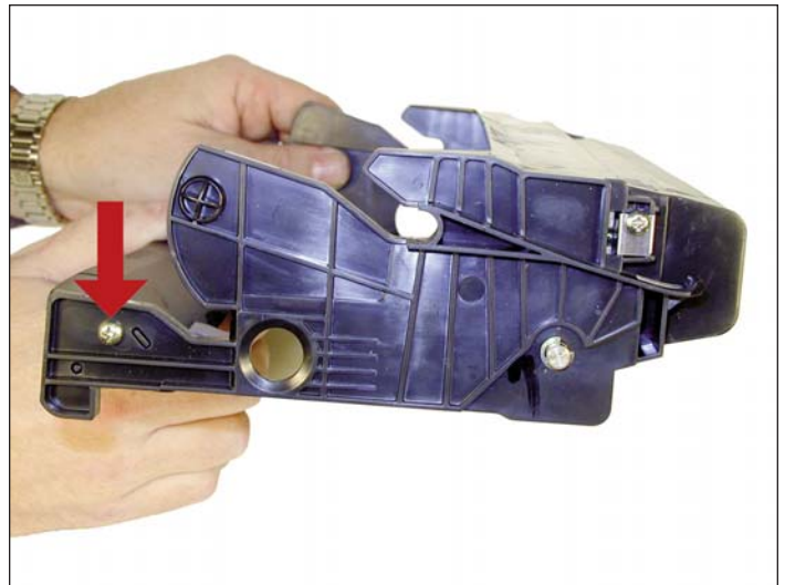
14. Instale el ensamble de la manija/candado del cartucho y sus dos tornillos.
