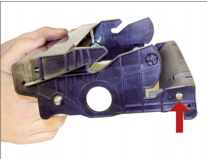
14. Instale el ensamble de la manija/candado del cartucho y sus dos tornillos.
