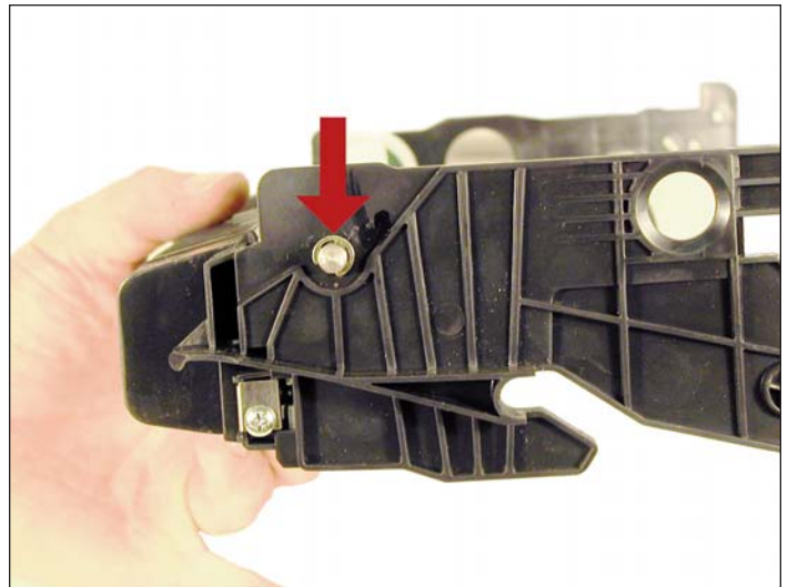
3. Remueva el anillo-E del lado de los engranajes pequeños del eje del cilindro.
