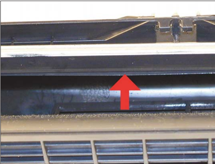
10. Limpie la cuchilla dosificadora con una mota de algodón y alcohol isopropílico al 99%.
