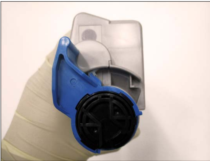
C. El Cartucho "Standard" de reposición tiene una tapa negra, lo cual hace posible el reciclaje del mismo (vista de la manija azul).
