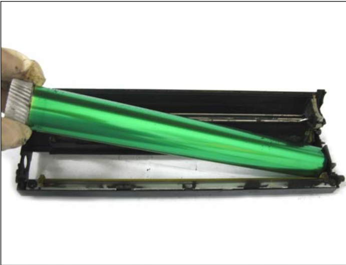
18. Instale el cilindro y el rodillo revelador como se muestra en ambas imágenes.
