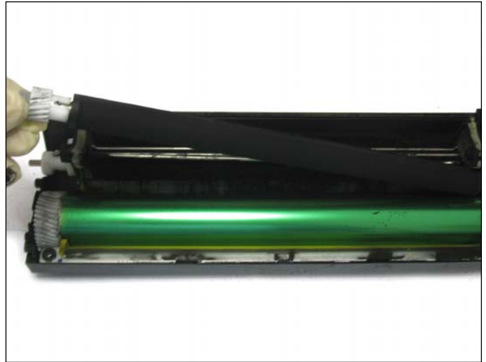
18. Instale el cilindro y el rodillo revelador como se muestra en ambas imágenes.
