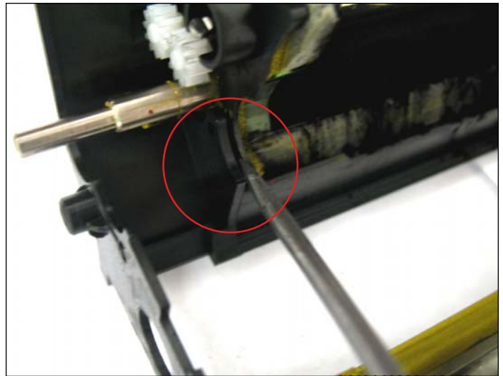
15. Remueva la assembly del rodillo de alimentación mediante al liberar la caja como se muestra en la imagen.
