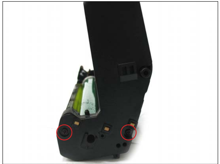
9. Remueva los dos tornillos mostrados en la imagen adjunta y afloje la tapa que estos sostienen.
