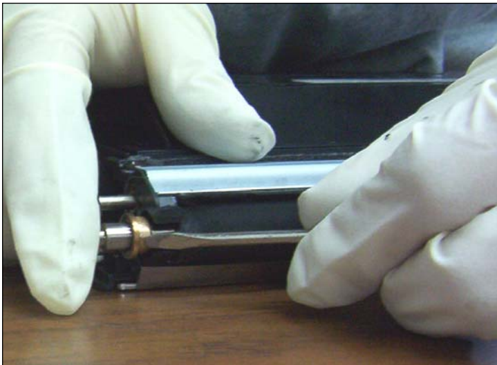
7. Sacar el buje metálico que mantiene el eje en su lugar cerca de donde el tapon de llenado de toner esta ubicado. El buje opuesto puede permanecer en su lugar.
