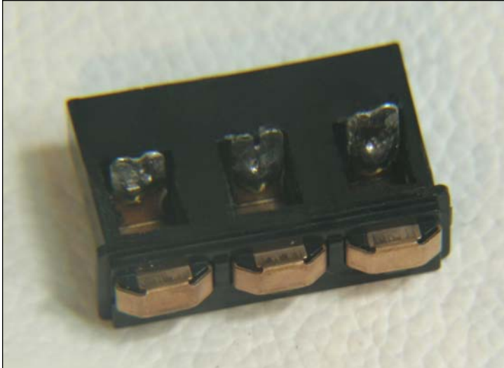
6. Conector con el chip extraído.
