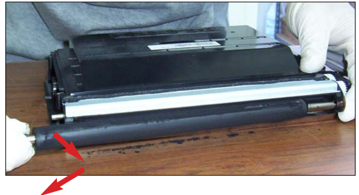
8. Deslizar el rodillo hacia afuera del cartucho.
