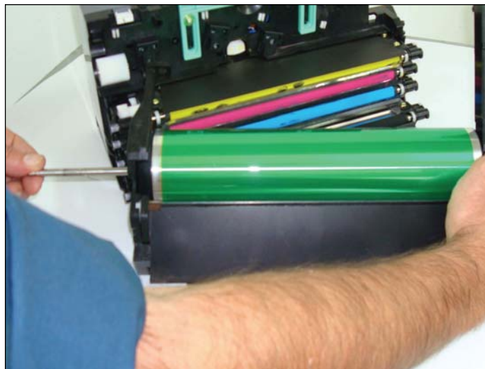
Ilustración 32. Inserción del eje desde lado engranaje.
