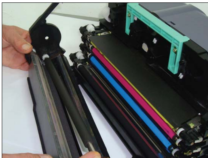
Ilustración 29. Montaje del PCR.
