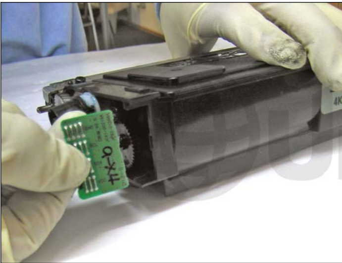
11. Sacar el chip como se muestra.
