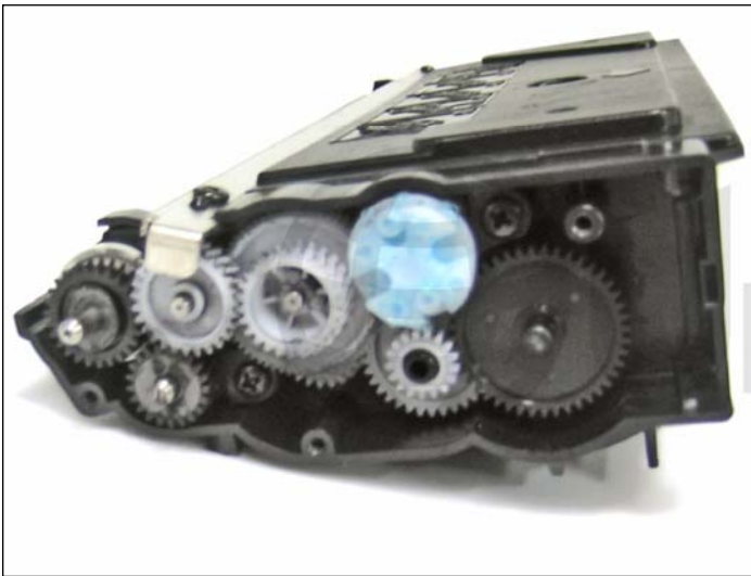
13. Extraiga el resto de los engranajes como se muestra.
