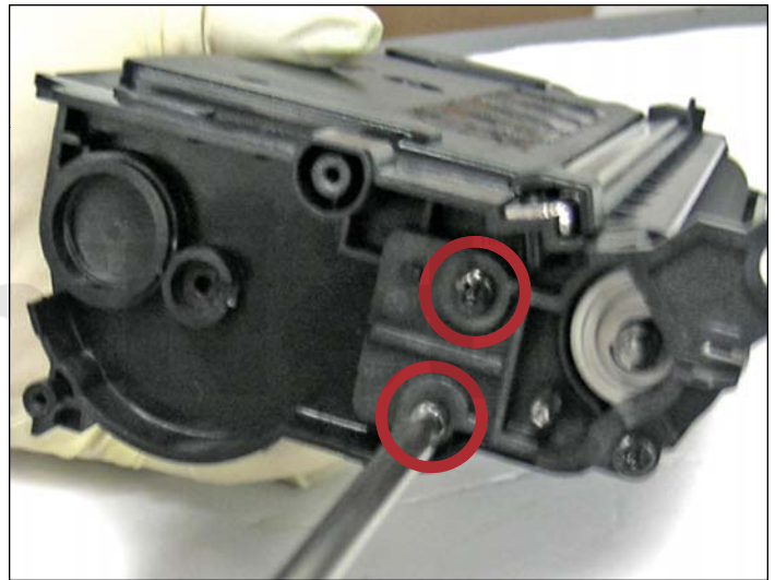
6. Del lado de los engranajes retire los dos tornillos que sujetan el soporte del rodillo de revelación, como muestra la foto.
