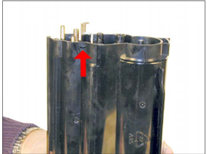
13. Instale la pequeña cubierta lateral interna. Asegúrese que esté colocada correctamente.
